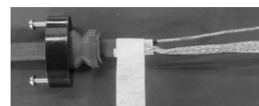
18. Die Tüllen an der Kante des Bandes installieren.
