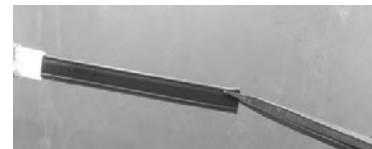
13. Corte cuidadosamente el área central (núcleo) entre los dos cables de la barra colectora.
