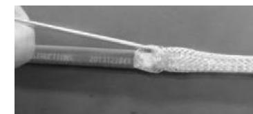
8. Formare una spirale con l'intrecciatura al centro del cavo a formare un filo intrecciato.
