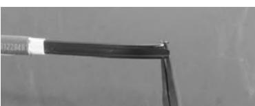
14. Doble y retire cuidadosamente el material del núcleo.
