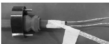
19. Inserte los cables de calefacción en la caja principal.
